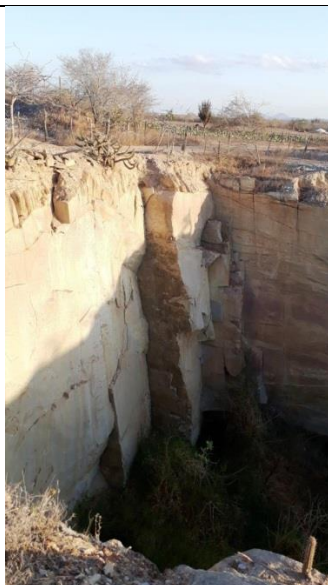
Foto 6.2.4.3-41 - Extração em jazida granítica, com modificação severa da orografia e paisagem natural (PAvN-03: Campina Grande, PB).
