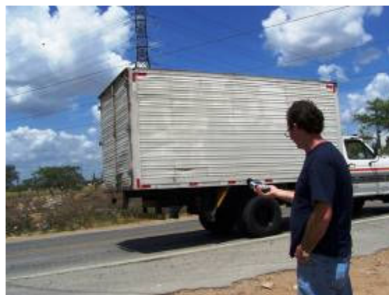
Fig. 35: medição com decibímetro na ADII do empreendimento.
