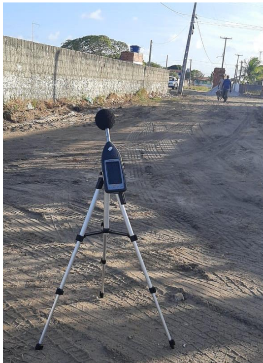
Figura 23. Exemplo de aferição de nível de pressão sonora com sonômetro.
