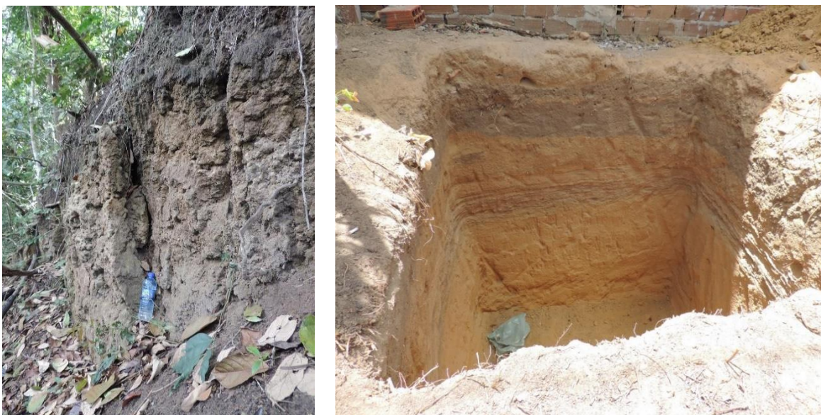
Figura 22- Seção do perfil do Argissolos em exposição em corte de projeto de fossa séptica e talude natural.
