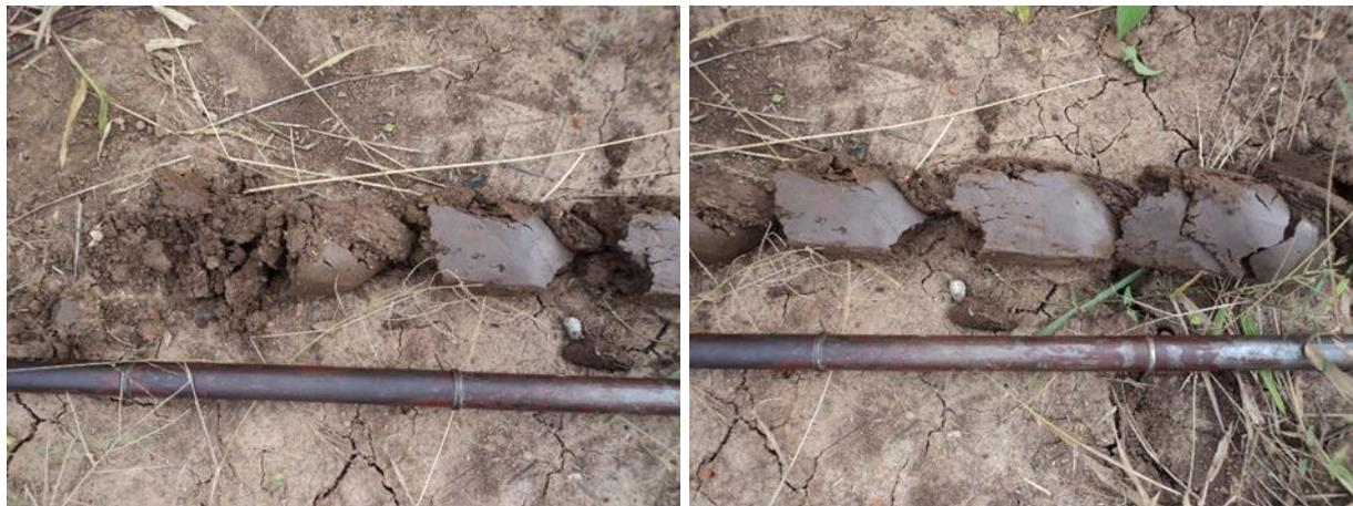
Figura 4.27 – Aspecto de estruturas cuneiformes na unidade VXo em profundidade de 0,7m
