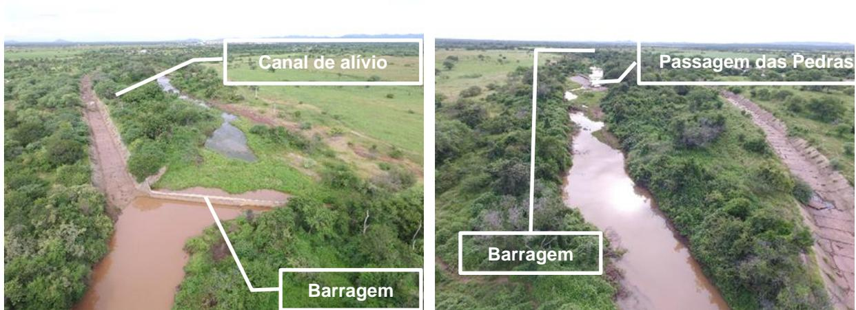
Principalmente a jusante do sítio paleontológico e do Canal de Alívio, nota-se que o leito do rio do Peixe está bastante assoreado, possivelmente em decorrência da alteração da dinâmica hídrica pela implantação dos dispositivos necessários para a retirada de água do local onde se observam as pegadas (**Figura 4.35**). O pisoteio pelo gado também pode contribuir com o desmoronamento das margens e assoreamento do leito do rio do Peixe (**Figura 4.36**).
