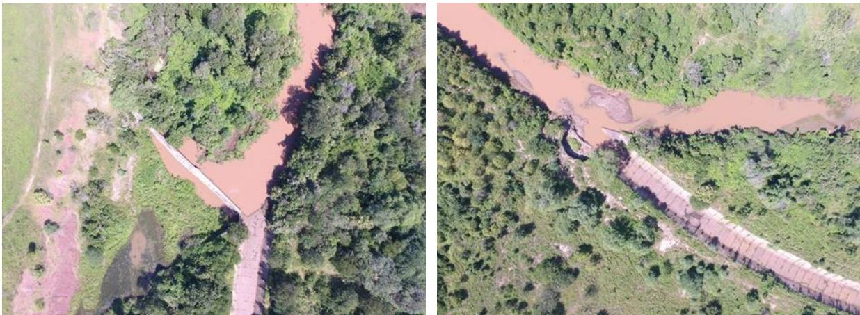
Alguns trechos do canal de alívio apresentam suas margens e leito bastante degradados. Tal situação pode indicar a necessidade de adequações construtivas a fim de garantir sua resistência em vazões de caudais.
